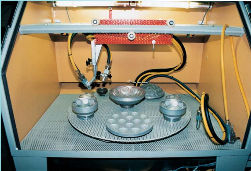
Düsenhalter für die individuelle Einstellung Nozzle holder for individuell adjustment
